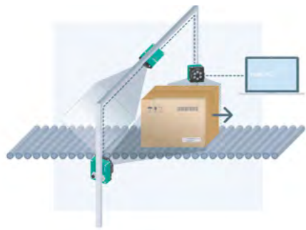
Lojistik uygulamalarında çoklu kamera yapısı ile farklı yüzeylerdeki 1-D ve 2-D kodları okuma
